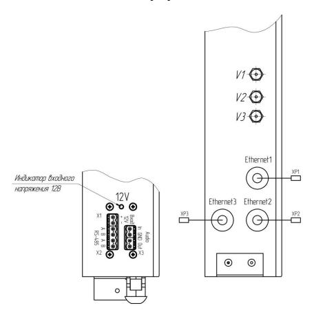
V1-V3 – Разъемы для подключения аналоговых видеокамер;
