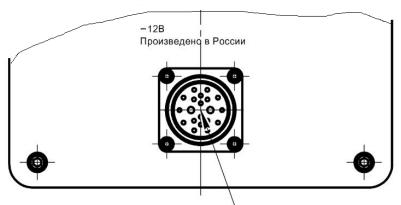
Разъем для подключения тепловизора
