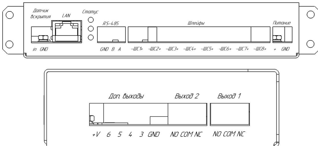
Датчик вскрытия – Разъем для подключения внешнего датчика вскрытия
