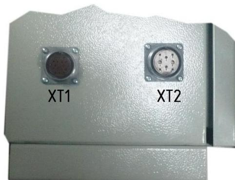
XT1 – Разъем для подключения бензогенератора из состава STL-724.
