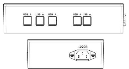
USB A – разъемы выходного напряжения постоянного тока 5В для подключения заряжаемых устройств;
