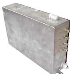
Предназначен для оцифровки и сжатия видеосигнала от четырех аналоговых видеокамер. Имеет дуплексный аудиоканал для подключения аудиодомофонной панели STS-745. Имеет порт RS-485 для подключения телеметрии, например, поворотной видеокамеры. Исполнение IP65. Может поставляться как отдельно, так и в составе контроллера STS-504, как готовое решение комплексной системы безопасности. Применяется для организации видеонаблюдения на периметре объекта.
