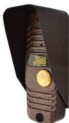
Аудиодомофонная панель с кнопкой вызова. Предназначена для организации двусторонней аудиосвязи, подачи сигнала «Тревога». Возможно параллельное подключение до 30 панелей на 1 дуплексный аудиоканал IP-видеосерверов STS-301K, STS-312 или БВ4. Поддерживается посылка сигнала вызова на определенную панель с АРМ «Синергет КСБО». Исполнение IP65.
