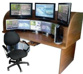
Предназначено для размещения оборудования из состава «Синергет КСБО», с целью организации рабочего места дежурного оператора. Позволяет разместить 3 монитора с диагональю 32" и 6 мониторов с диагональю 19". Содержит KVM переключатель для управления тремя АРМ оператора при помощи одной клавиатуры и мыши. Имеет в составе 19" шкаф для размещения трех АРМ «Синергет КСБО», размещающийся под столом.
