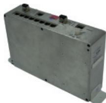
Предназначен для организации сети Ethernet по оптической линии связи. Имеет 6 портов Ethernet 1 Гбит/с и 2 оптических порта LC со скоростью 1Гбит/с. Оптические порты предназначены для работы с одномодовым оптоволоконном. Имеется режим «холодного старта». Два оптических порта позволяют организовать сеть Ethernet на протяженном участке, используя одномодовый оптический кабель.
