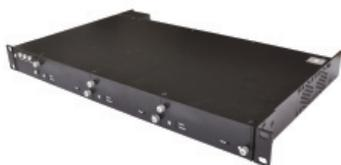
Предназначен для оцифровки и сжатия видеосигнала от двенадцати аналоговых видеокамер. Имеет три дуплексных аудиоканала для подключения аудиодомофонных панелей STS-745. Предусмотрены порты RS-485 для подключения телеметрии, например, поворотной видеокамеры. Имеет встроенный детектор движения. Исполнение в металлическом корпусе в 19" стойку. Применяется для организации видеонаблюдения внутри помещений.
