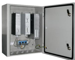
Специализированный монтажный шкаф с узлами крепления для установки блоков контроллера серии STS-504, в любых комбинациях. Имеет автоматический выключатель напряжения питания, датчик вскрытия корпуса и систему охлаждения. Дверца шкафа запирается на ключ.
