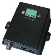
Предназначен для оцифровки и сжатия видеосигнала от одной аналоговой видеокамеры. Имеет дуплексный аудиоканал для подключения аудиодомофонной панели STS-745. Предусмотрен порт RS-485 для подключения телеметрии, например, поворотной видеокамеры. Имеет встроенный детектор движения. Исполнение в металлическом корпусе. Применяется для организации видеонаблюдения внутри помещения.
