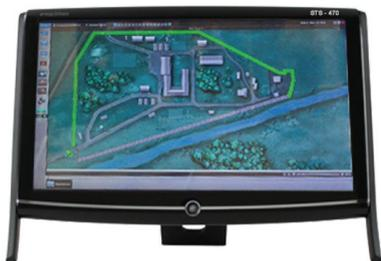
Интеллектуальный пульт индикации и управления предназначен для резервирования функций серверов и АРМ, а также упрощения процедуры управления системой при решении простых типовых задач. Пульт STS-470 оснащен сенсорным ЖК-дисплеем, обычно крепится на стену, что позволяет просто и удобно управлять системой безопасности объекта.
