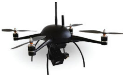
Беспилотный летательный аппарат (БПЛА) «Шмель» предназначен для решения задач по охране периметров объектов, рубежей государственной границы, объектов, расположенных на удалении, поисковых и разведывательно-поисковых действий. БПЛА оснащен оптико-электронным комплексом, цветной видеокамерой, или тепловизором на основе неохлаждаемого микроболометра. Управление БПЛА осуществляется при помощи планшетного компьютера. Корпус БПЛА изготовлен из композитных материалов. Система
