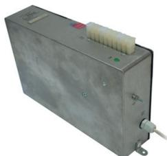
Предназначен для питания потребителей стабилизированным постоянным напряжением 12В, суммарной максимальной мощностью до 320 Вт, преобразованным из переменного напряжения 220В. Исполнение IP65.
