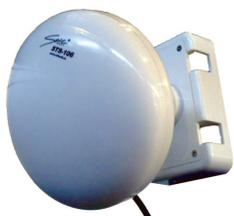
Радиолучевой, двухпозиционный извещатель движения предназначен для контроля за перемещениями объектов через протяженные периметры и состоит из приемного и предающего блоков. Извещатель создает между блоками электромагнитное поле и контролирует его изменение. Цифровая обработка сигнала позволяет снизить вероятность ложных срабатываний от птиц, мелких животных, качающихся веток деревьев. Исполнение IP65.
