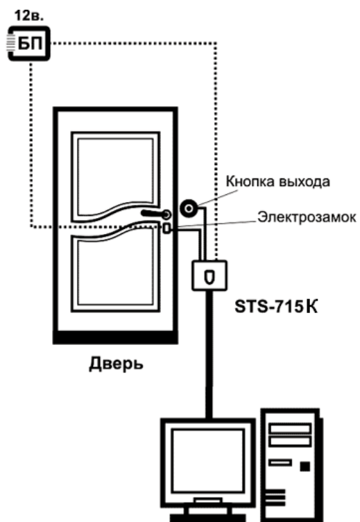
Пример схемы подключения STS-715K
