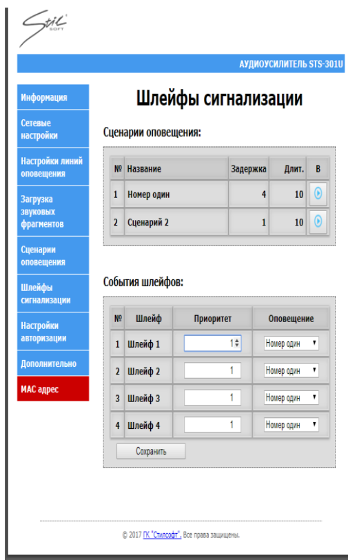
Рисунок 13 – Окно настройки шлейфов сигнализации
