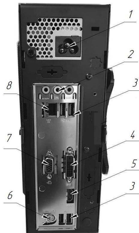
Рисунок 1 – Подключение системного блока (расположение и внешний вид разъемов может отличаться от приведенного)
