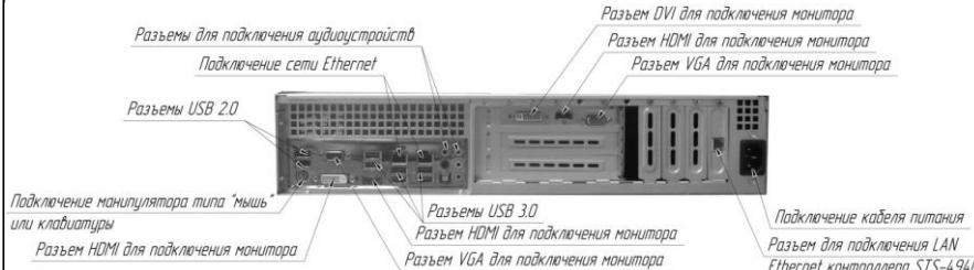
Рисунок 1 – Подключение сервера (расположение, внешний вид, типы разъемов и их количество может отличаться от приведенного).
