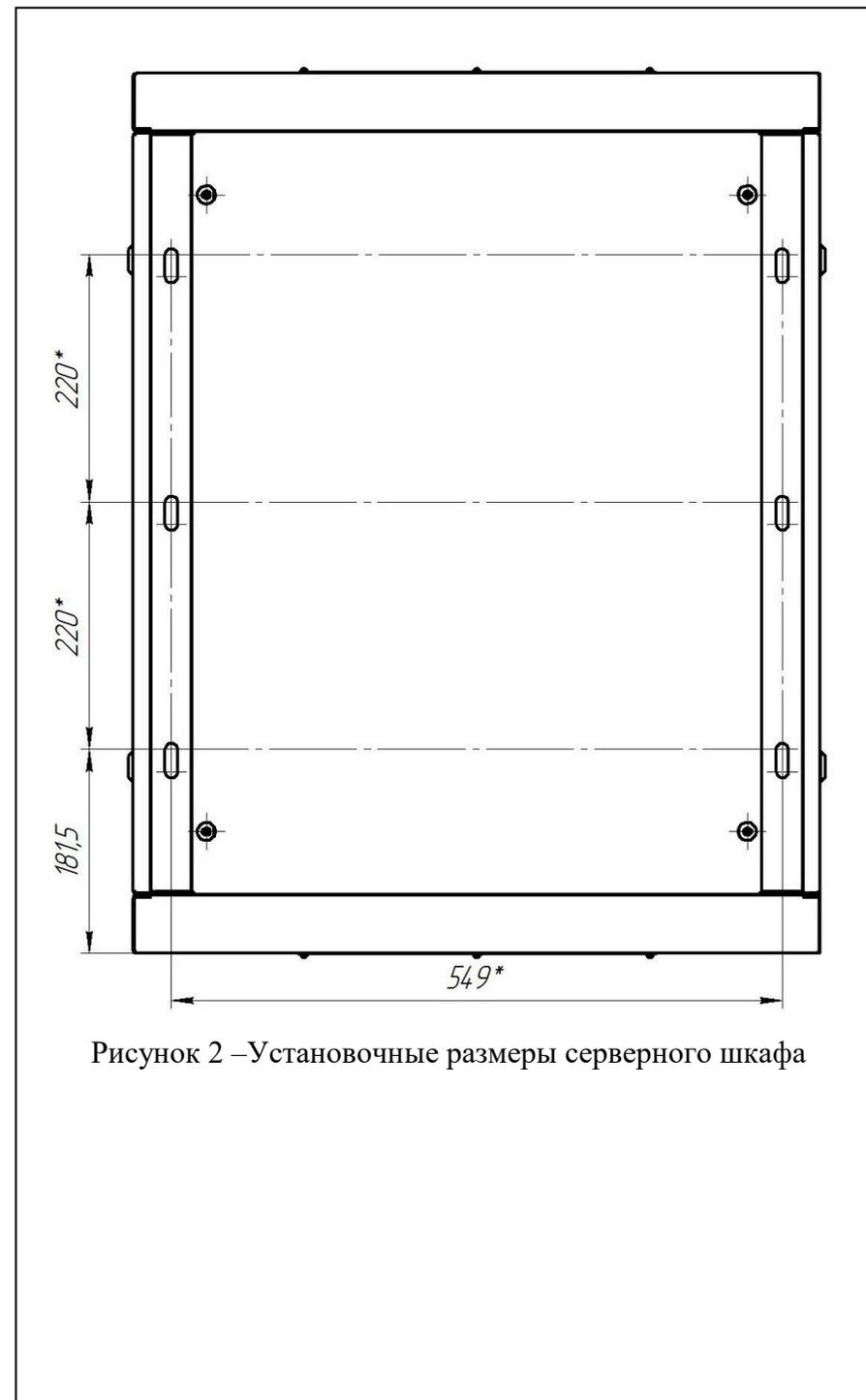
Рисунок 2 – Установочные размеры серверного шкафа
