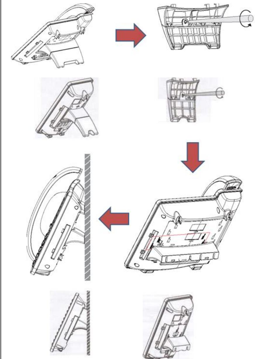
Рисунок 2 – Монтаж IP телефона к стене
