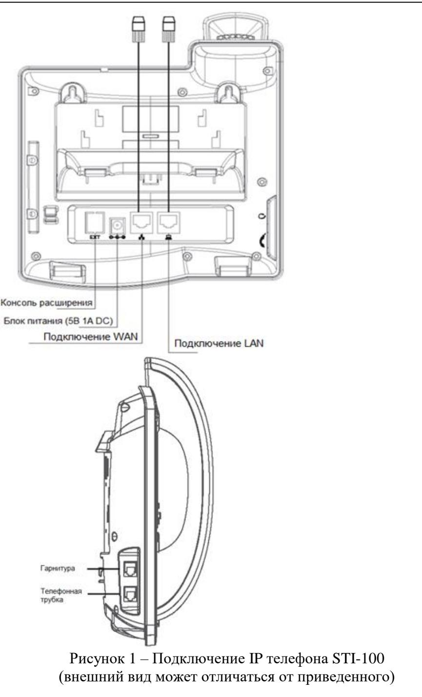
Рисунок 1 – Подключение IP телефона STI-100 (внешний вид может отличаться от приведенного)
