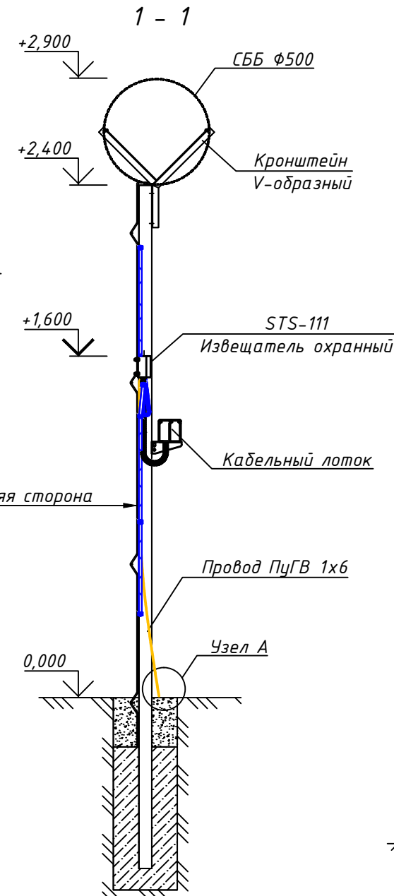
Фрагмент крепления чувствительного элемента на сетчатом ограждении
