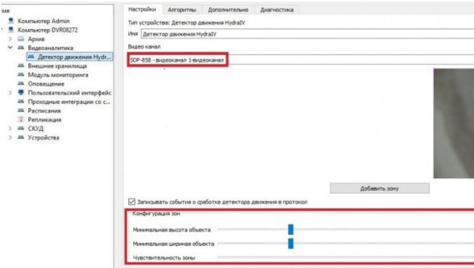
5. Выберите «Видеоканал», на вкладке «Устройства» удалите встроенный детектор и добавьте «Детектор движения HydraIV». Нажмите «Применить».
