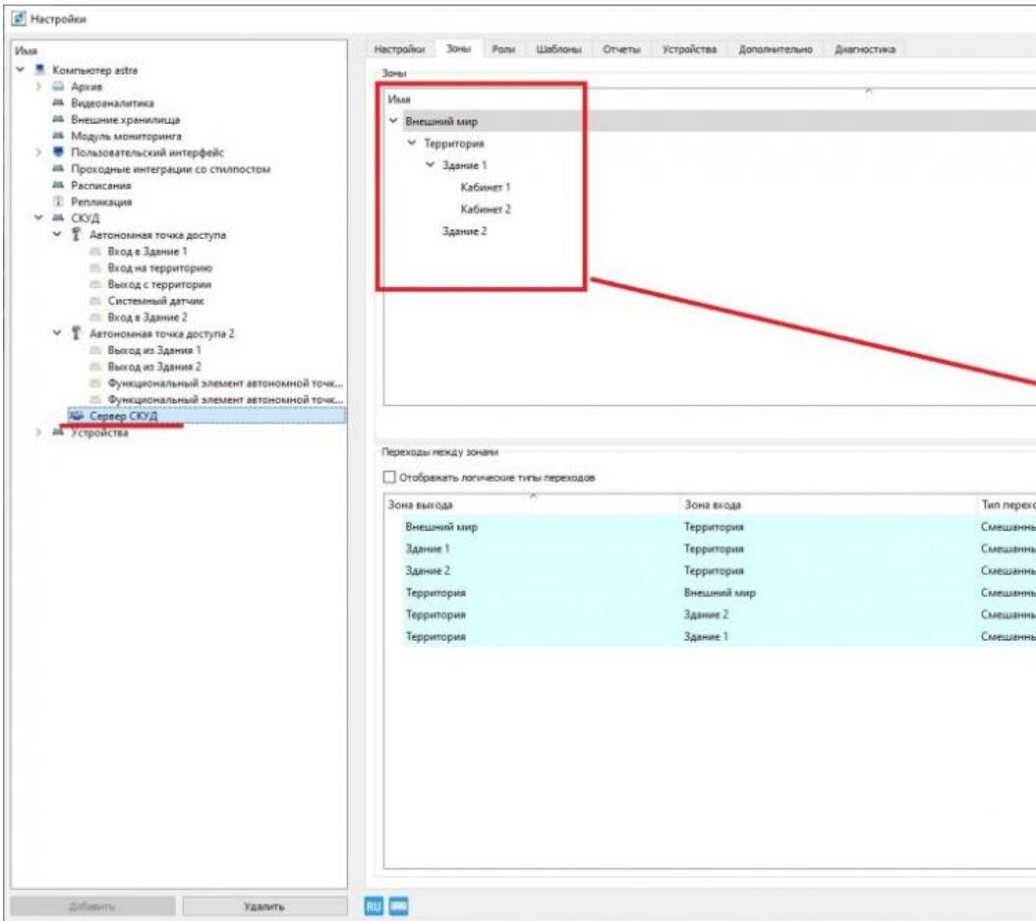
2. Задайте для каждой точки прохода (функционального элемента) точку доступа. Укажите, в какую зону контроля ведет проход по функциональному элементу и какую зону контроля покидаете, пройдя через этот функциональный
