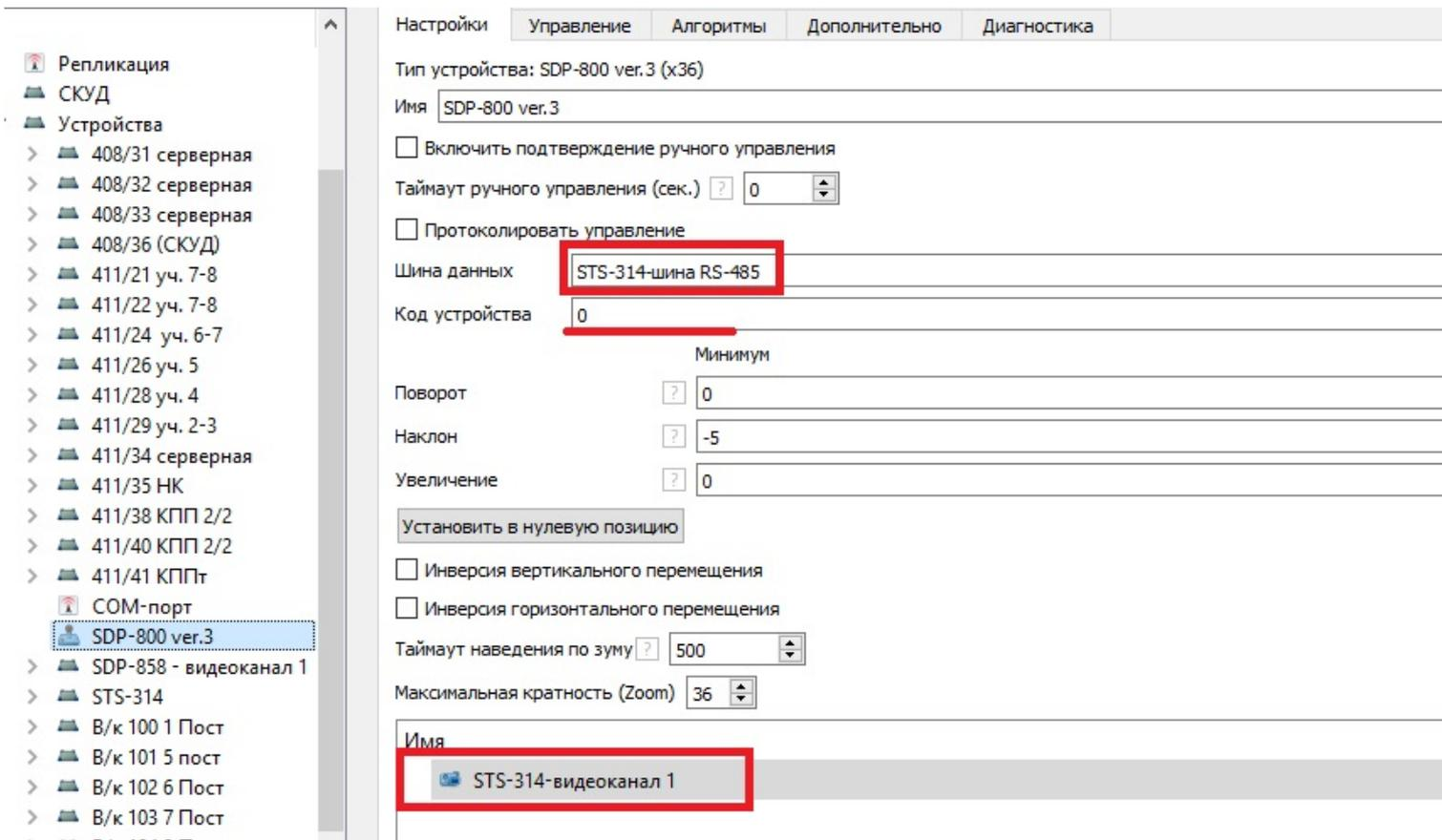
3. В настройках STS-314 в web-интерфейсе, для «шины» RS485 установите скорость 2400. Для это перейдите в меню «Настройка», затем «Настройка входов/выходов» и перейдите в «UART». Установите «Тип» – «RS485-SerialOverIP», поставьте галочку «Сервер TCP» и нажмите «Сохранить».
