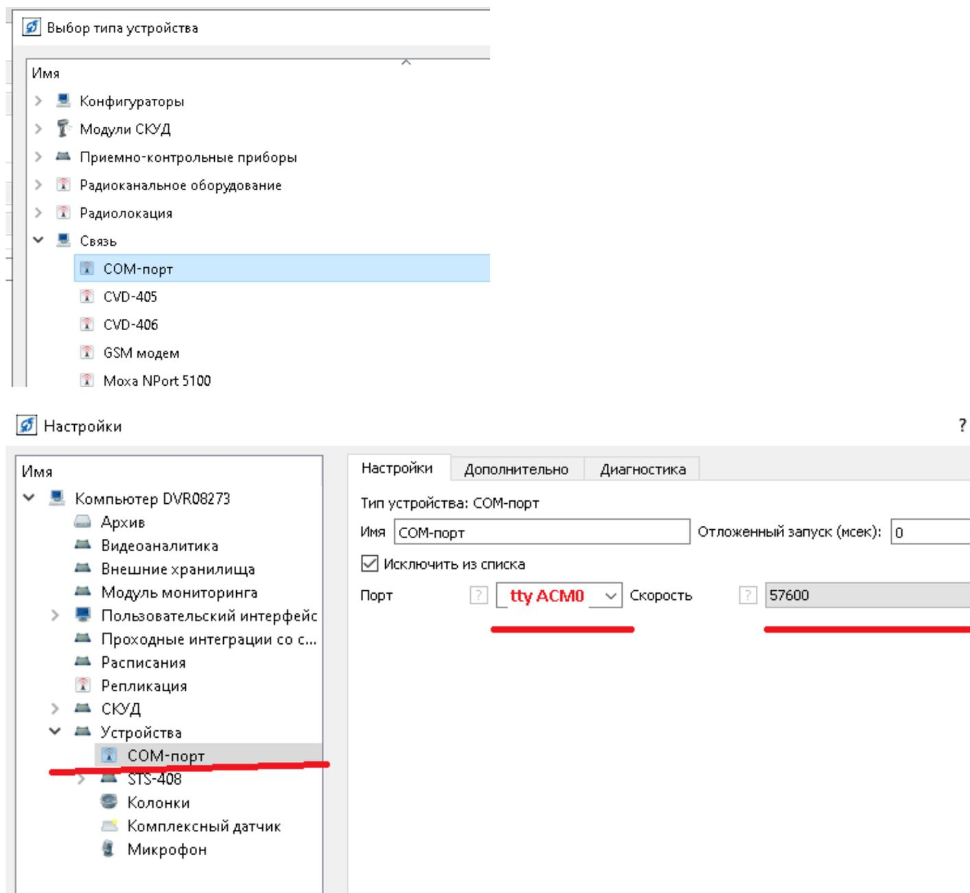
Добавьте Модуль STS-709 (Модули СКУД), в настройках которого в пункте «Шина данных» укажите «СОМ-порт».
