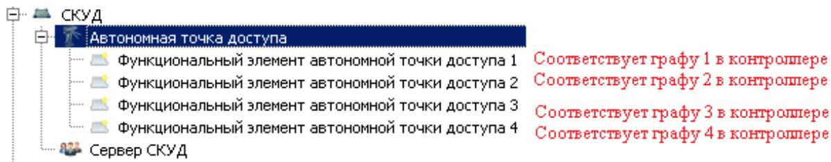
Неиспользованные функциональные элементы деактивируйте (например, если контроллер используется для подключения одной двери, граф 1 – Вход, граф 2 – Выход).
