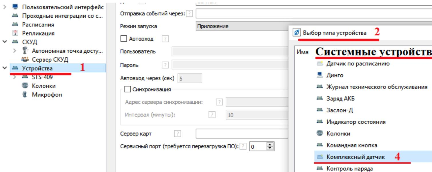
Зайдите в раздел «Комплексный датчик», в поле «Контролируемые устройства» добавьте датчики, которые Вам нужны.
