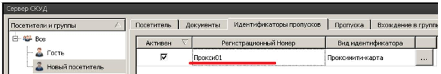
Далее нажмите на кнопку «...» и поднесите проксимити карту к считывателю (считыватель должен быть указан в настройках как «Считыватели для добавления пропусков»).
