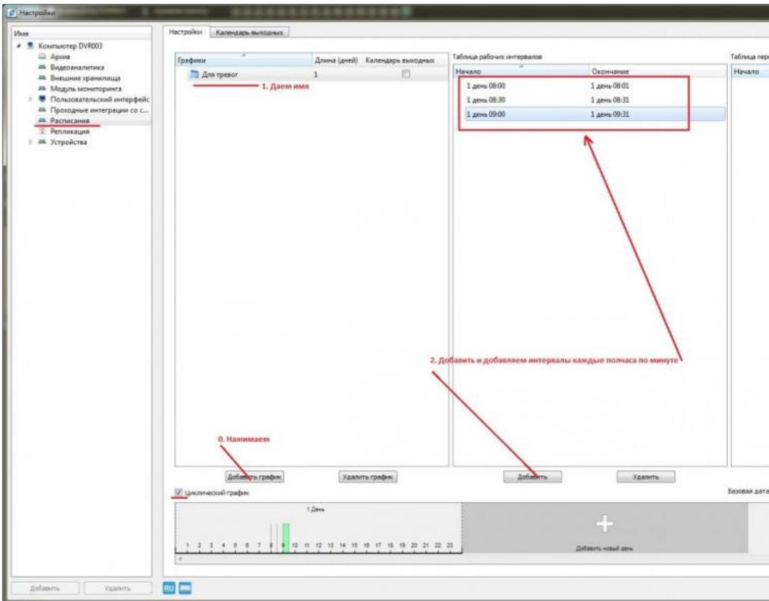
2. Выберите в списке устройств добавленный датчик, укажите созданное расписание. На вкладке «Алгоритмы» добавьте алгоритм «Тревоги при сработке с постановкой на охрану».
