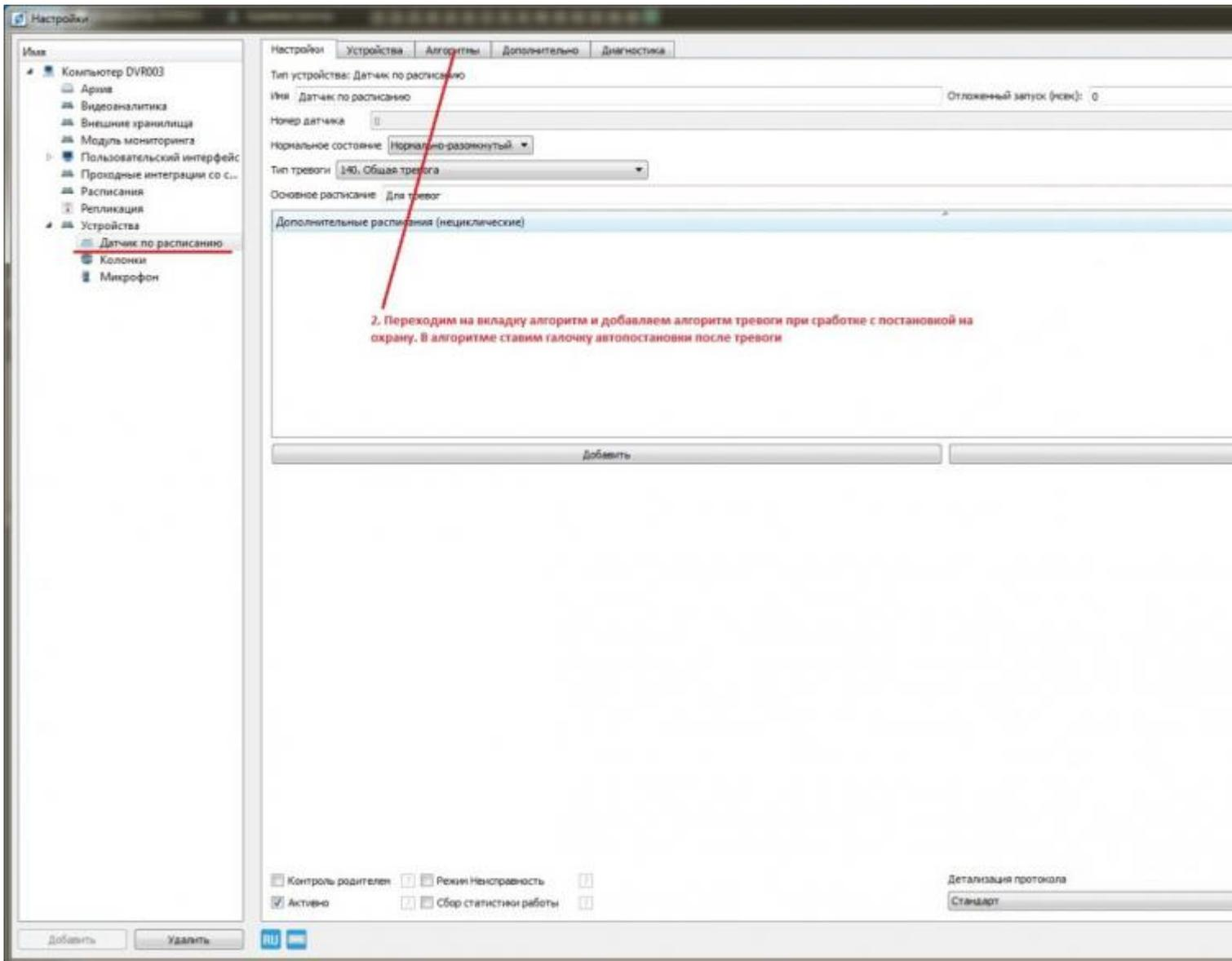
2. Переходим на вкладку алгоритм и добавляем алгоритм тревоги при сработке с постановкой на охрану. В алгоритме ставим галочку автопостановки после тревоги
